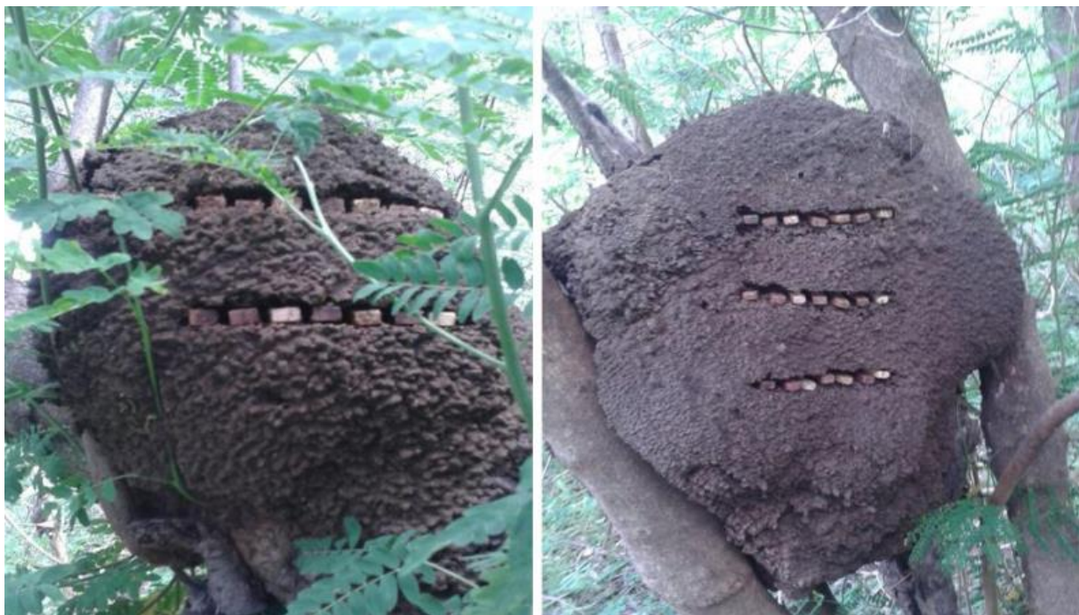
FIGURA 1. Implantação e distribuição dos corpos de provas das espécies madeireiras em colônias arborícolas de N. corniger , no município de Patos, Paraíba, Brasil.
