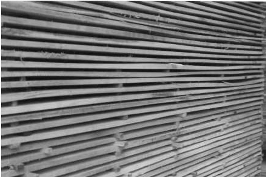
Figura 3. Variación en espesor de la madera aserrada de encinos
