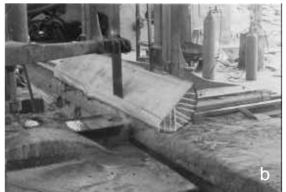
Figura 1. Sistema de corte tradicional (a) y de aserrío radial (b)
