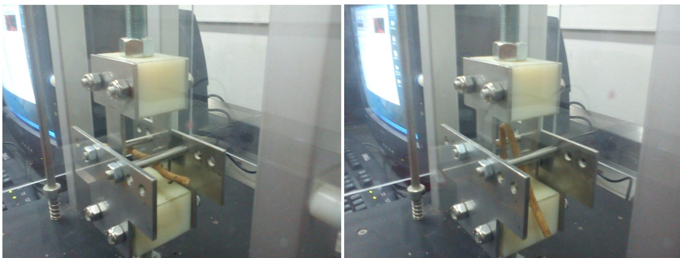
FIGURA 2. Montaje de la raíz en el dispositivo para prueba de flexión.
