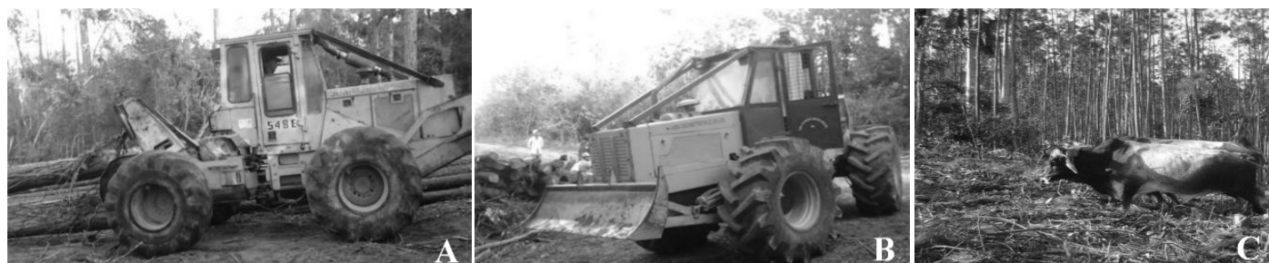
FIGURA 2. Equipos de extracción de madera de la empresa forestal Macurije: A) skidder John Deere 548E; B) skidder J-80A y C) yunta de bueyes.
